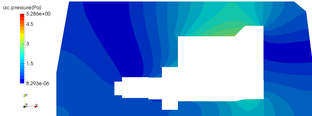
Obrázek B.12: Rozložení akustického tlaku dle MKP pro f = 100 Hz.
