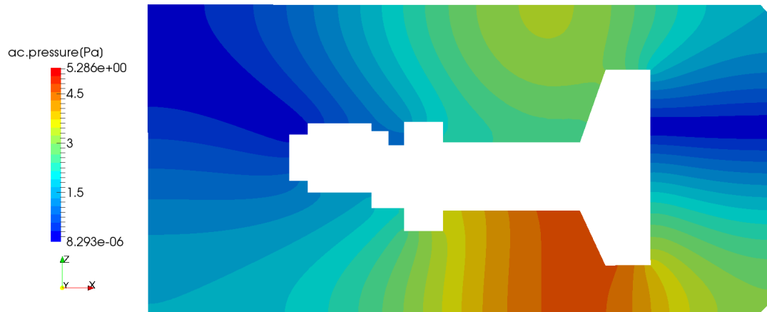
Obrázek B.14: Rozložení akustického tlaku dle MKP pro f = 100 Hz.
