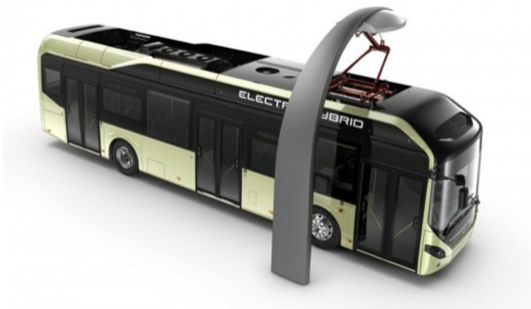
Obr. 13. Hybridní autobus Volvo 7900 Plug-in Hybrid s pantografickým dobíjením [19]
