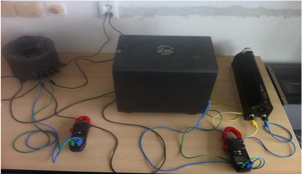
Obr. 25: Zapojení pro měření při zatížení
