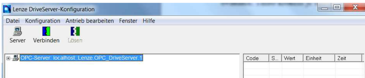
Obrázek 3.5 Lenze DriveServer Konfigurator – nastavení OPC serveru
