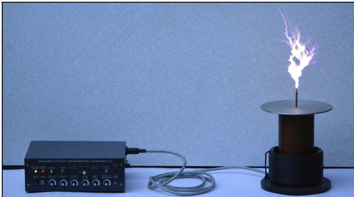
Obrázek 44: Fotografie praktické realizace Teslova transformátoru v chodu (CW režim)
