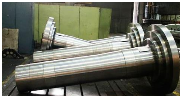
Obr. 2.14 Hřídel VTE vyrobena ve firmě Škoda Steel
