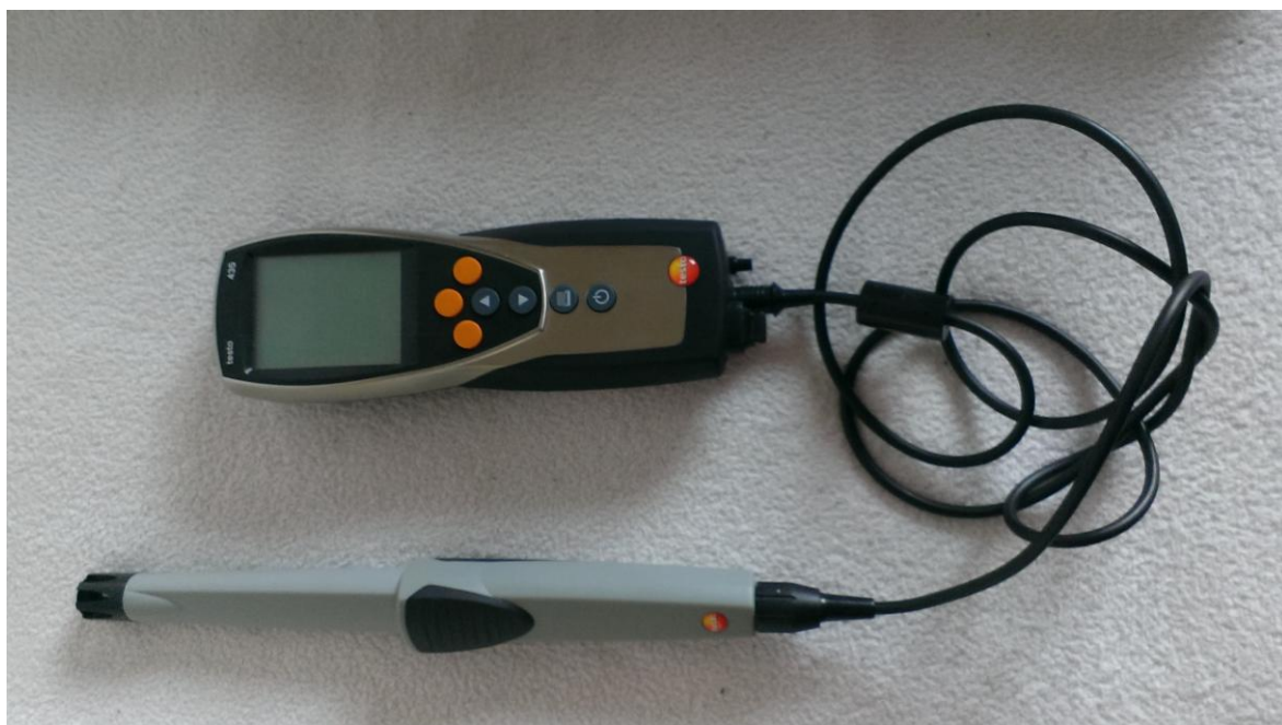
Obr. 0.2: Měřící přístroj TESTO 435
