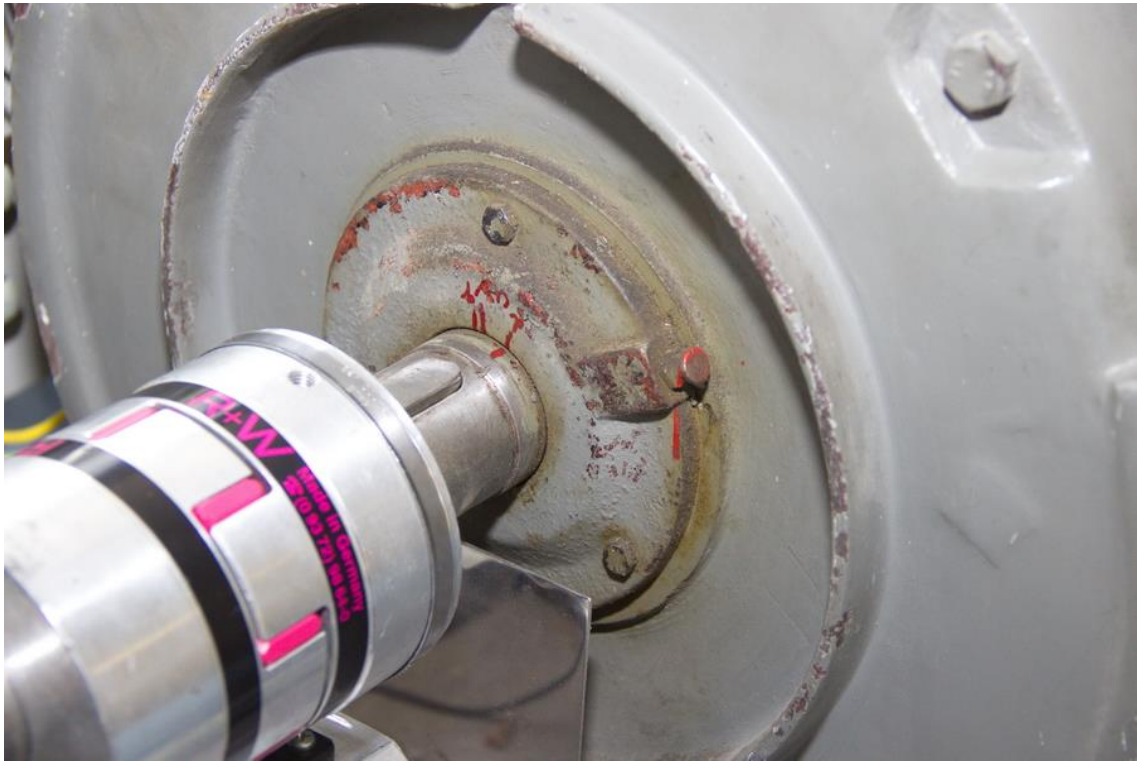
Obr. 5.7.3 Výstupní hřídel stroje s nastavením příčné a podélné polohy
