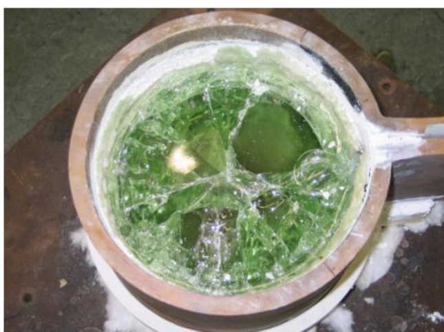
Obr. 2.2.1: Induktorový kelímek, tavení skla. [18]
