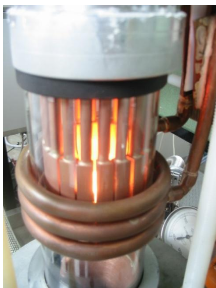
Obr. 2.8.2: Tavení na ingot, v rozmontovatelném kelímku.[29],[17]
