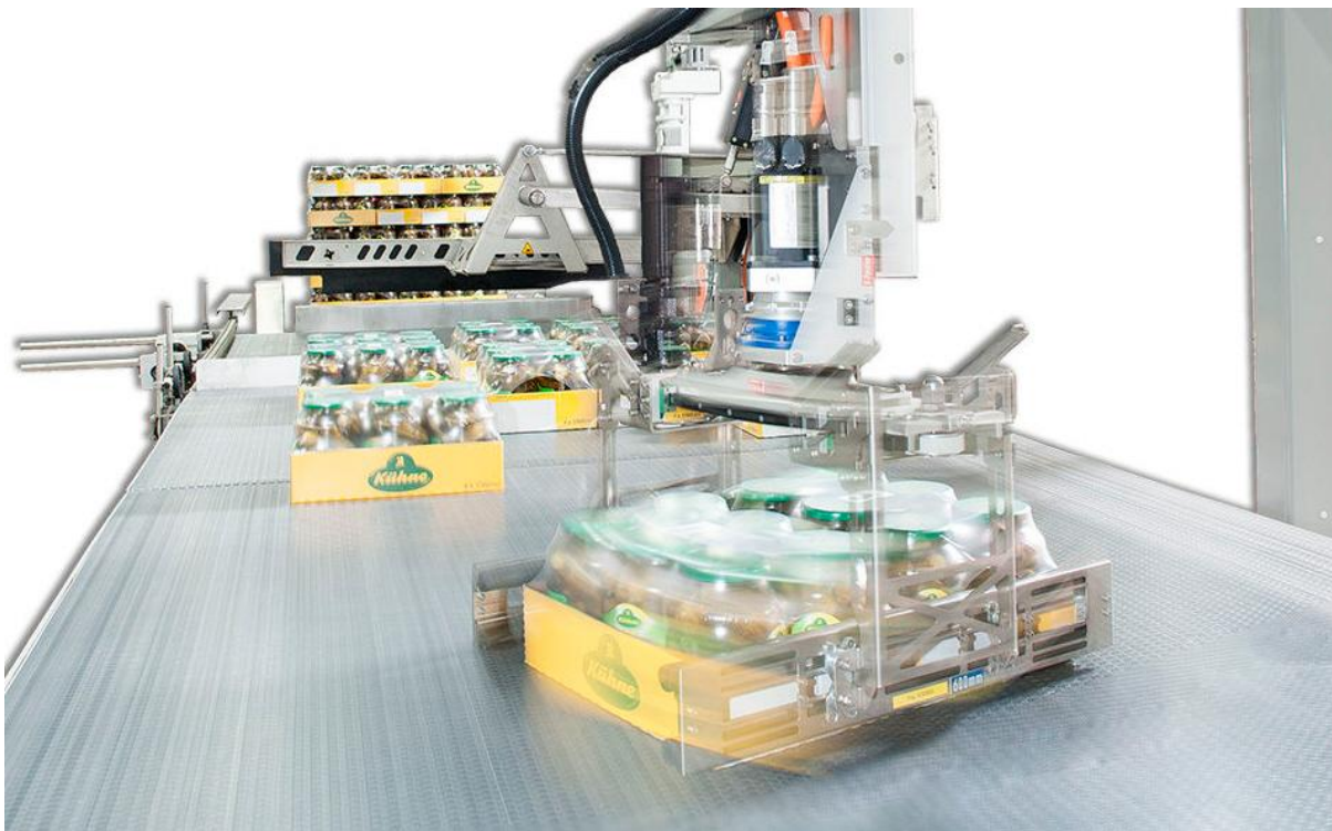
Obr 23 Robobox- Paletizér rovná kartony na správnou pozici na paletě
