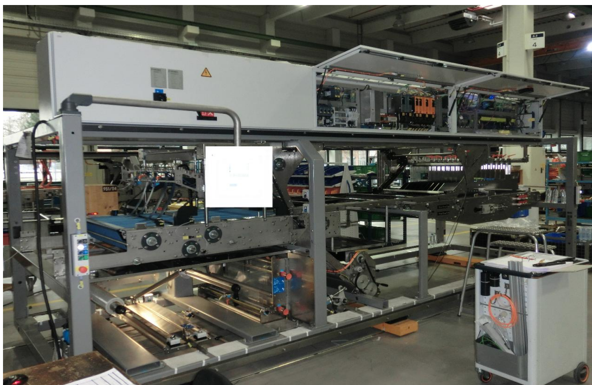
Obr 22 Teplotní tunel ve výstavbě
