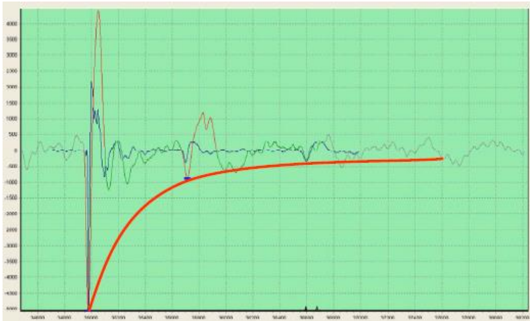
Obr. 18 Typický průběh útlumu na kabelu
