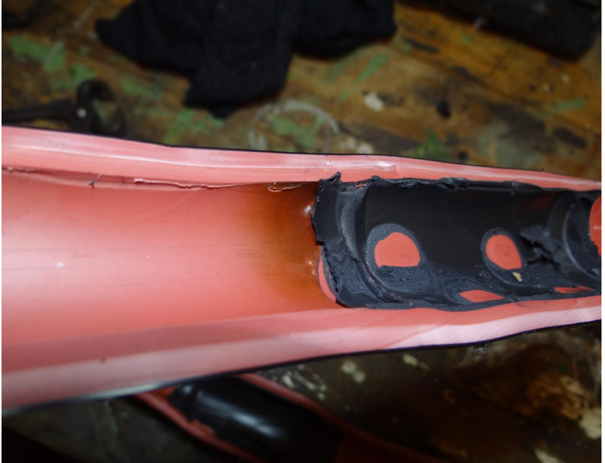
Obr. 23 Fotografie z rozboru vadné spojky
