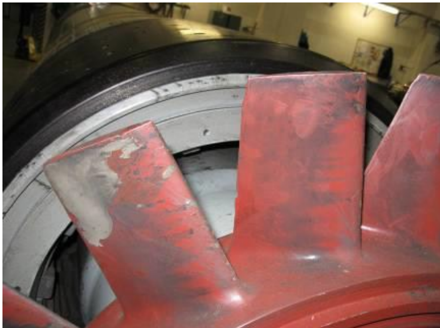
Obr. 1.34 Poškozená lopatka ventilátoru rotoru TG3 (převzato z [32])
