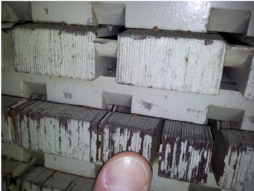
Obr. 1.29 Stator TG4 a detail uvolněných plechů magnetického obvodu
