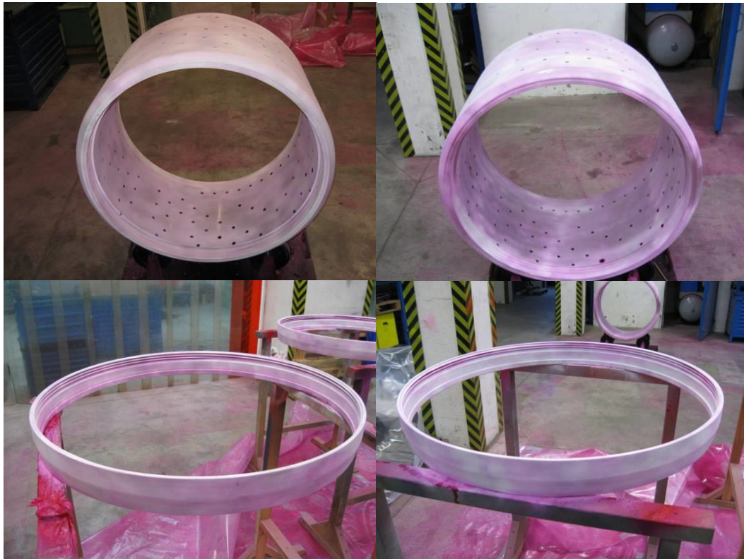
Obr. 1.36 Kapilární zkouška obručí a matic rotoru TG3 (převzato z [33])
