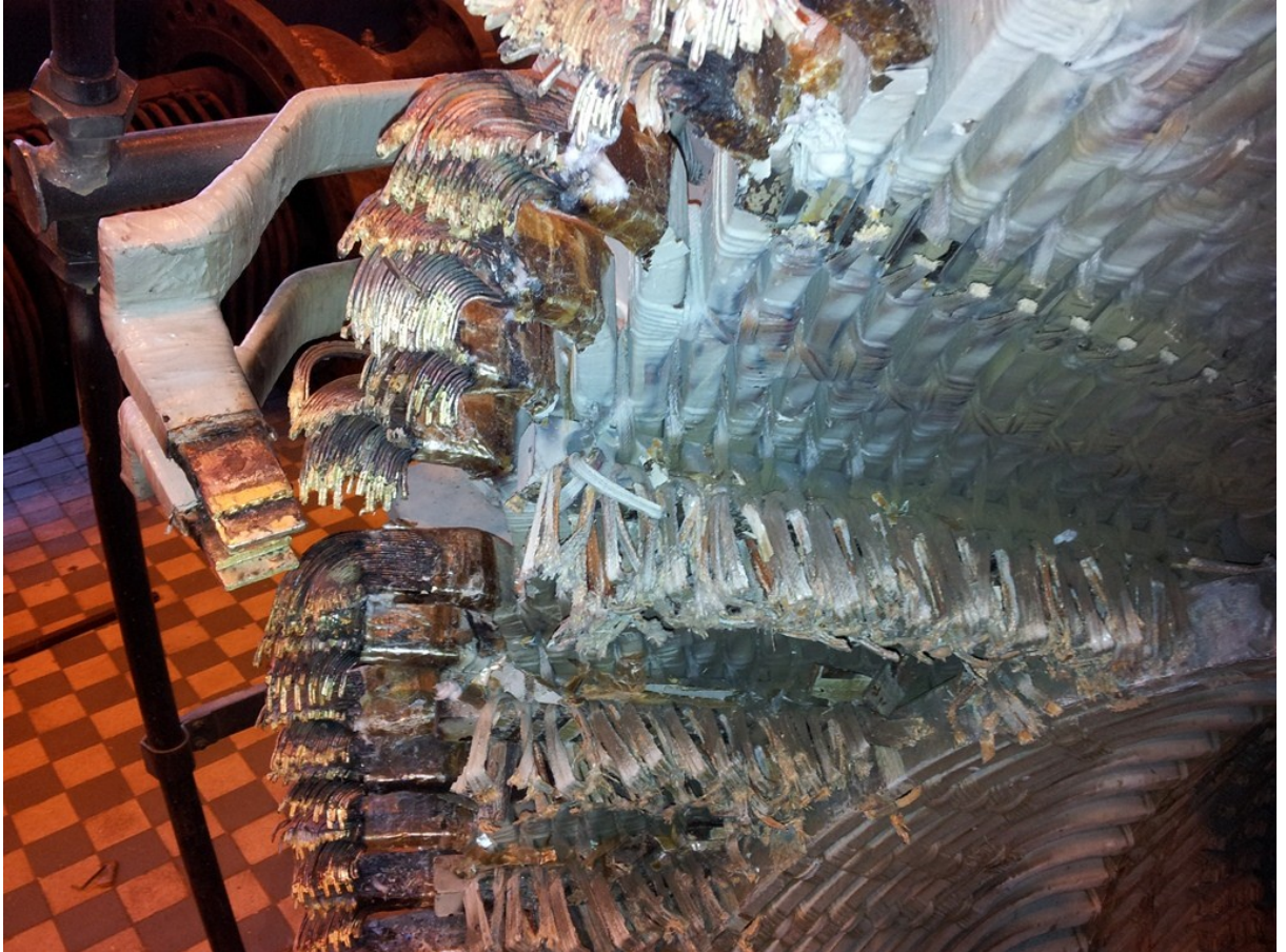
Obr. 1.28 Stator TG4 a detail po demontáži části statorových tyčí pro použití v TG3
