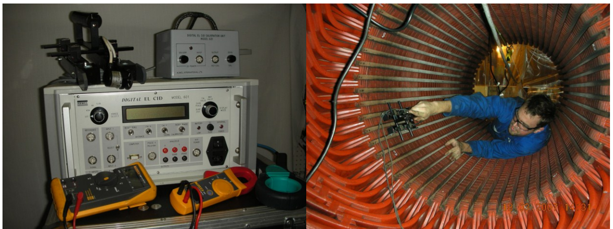
Obr. 1.17 Přístrojové vybavení a realizace magnetizační zkoušky EL CID (převzato z [19])
