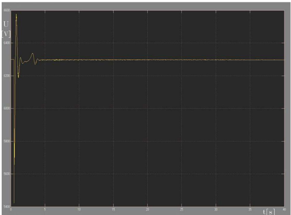
Obr.5.5.10 Výsledný průběh simulovaného napětí VS za transformátorem – první varianta
