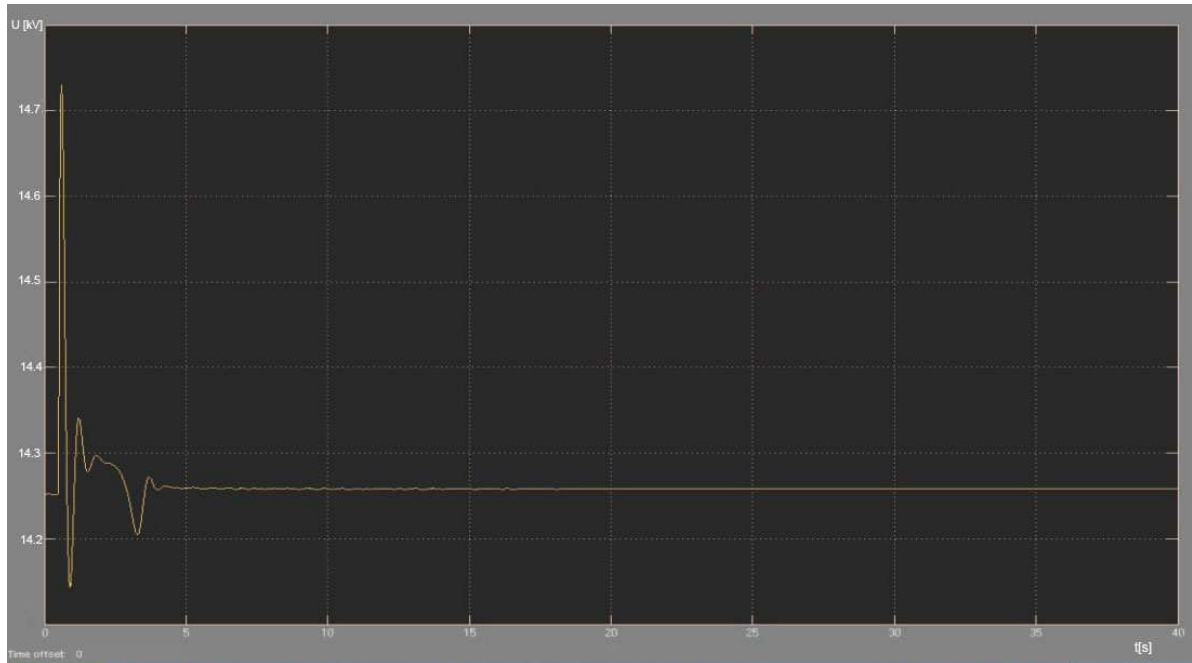
Obr.5.5.9 Výsledný průběh simulovaného napětí generátoru – první varianta
