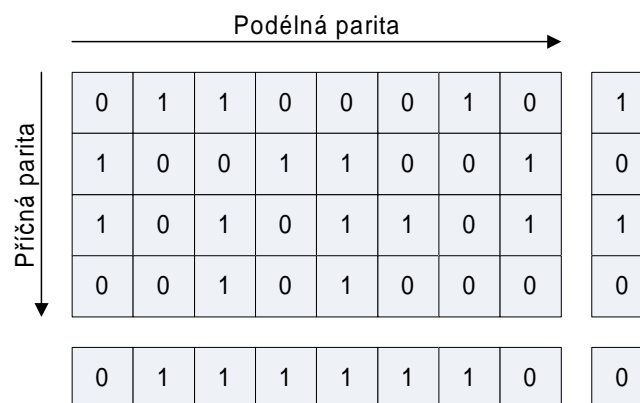
Obr. 2.8: Příklad doplnění zprávy sudou křížovou paritou
