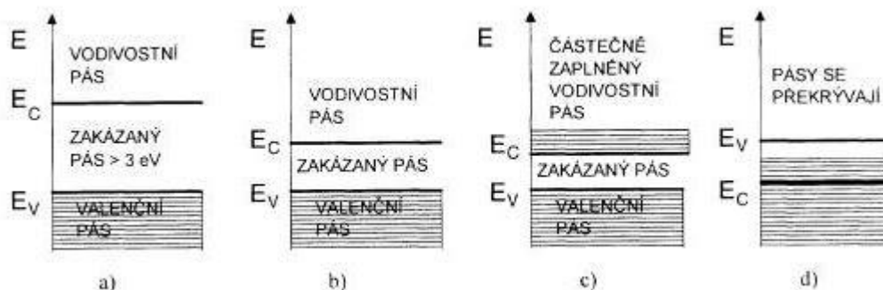
Obrázek 11 - Pásový model: a) izolant b) polovodič c) monovalentní kov d) bivalentní kov [23]
