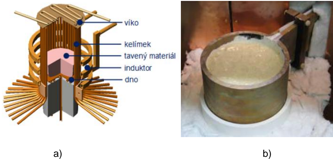
Obrázek 16: Schéma konstrukčního uspořádání studeného kelímku – a) segmentový kelímek [26], b) kelímek s integrovaným induktorem [27]
