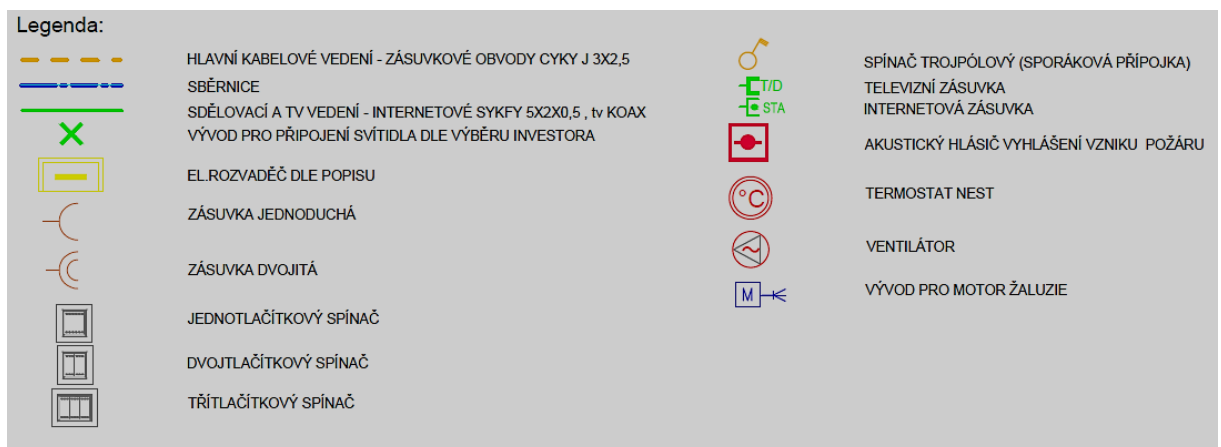
Obr.2.6 Legenda inteligentní elektroinstalace
