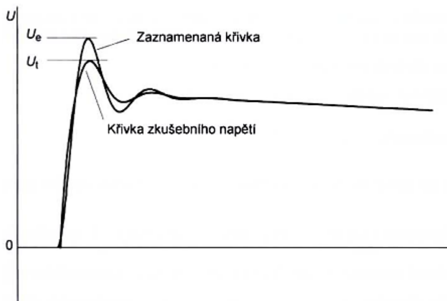
Obr. 4 Časový průběh zaznamenané křivky a křivky zkušebního napětí (převzato z [1, s. 51])
