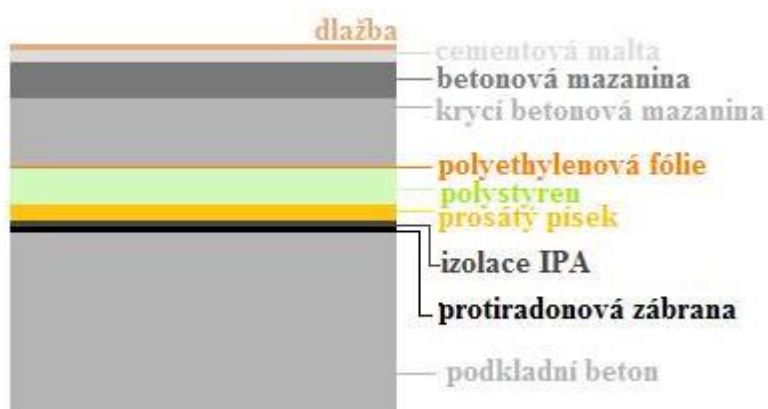
Obr. 4.5 Složení podlahy PDL
