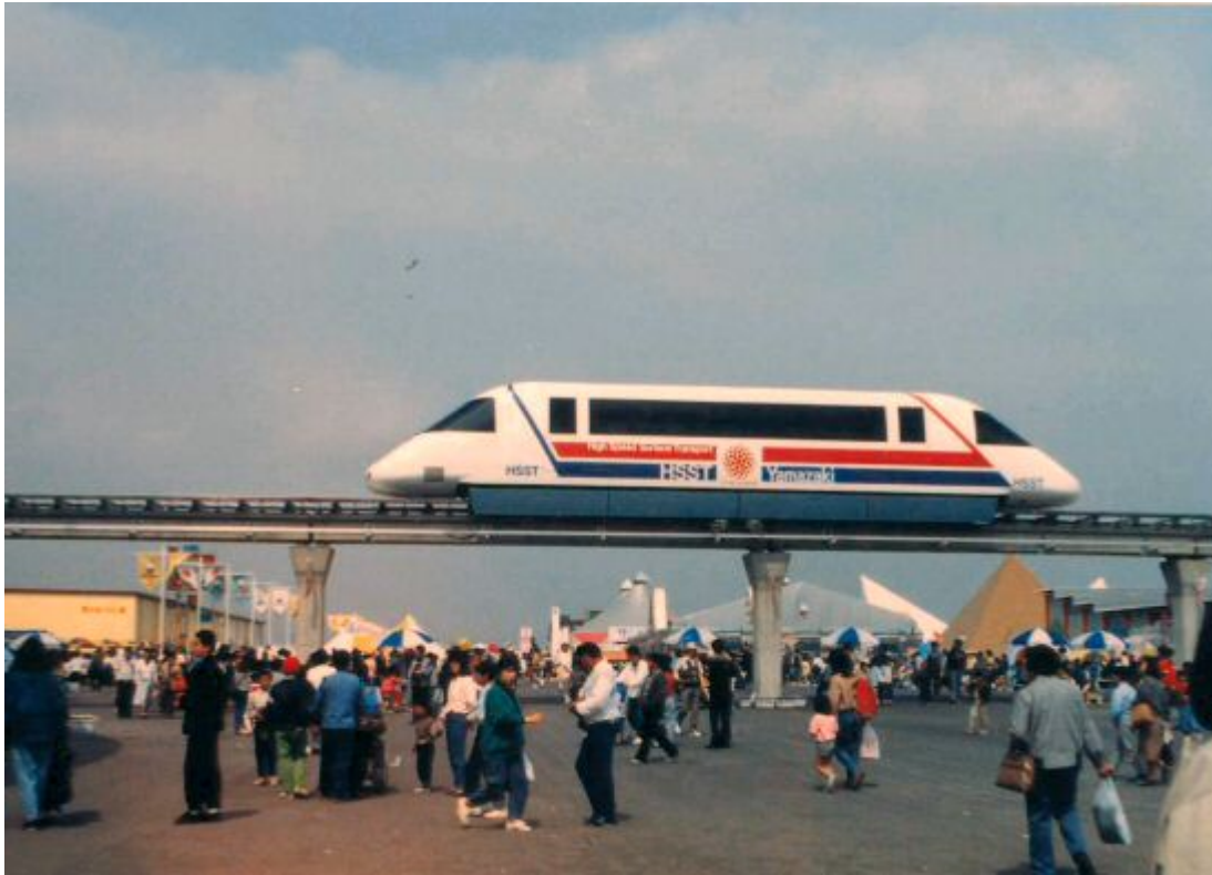
Obr. 22 magneticky levitovaný vlak HSST, výstava Expo88 [38]
