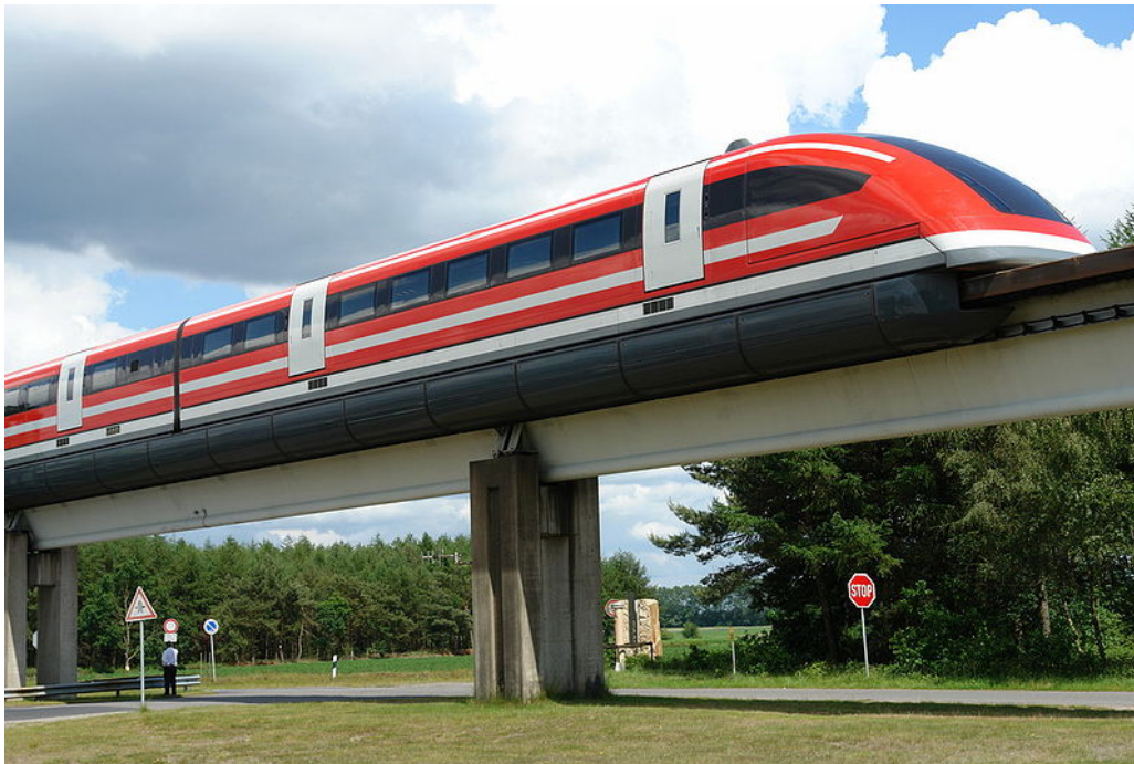
Obr. 25 Německý Transrapid využívající EMS [24]
