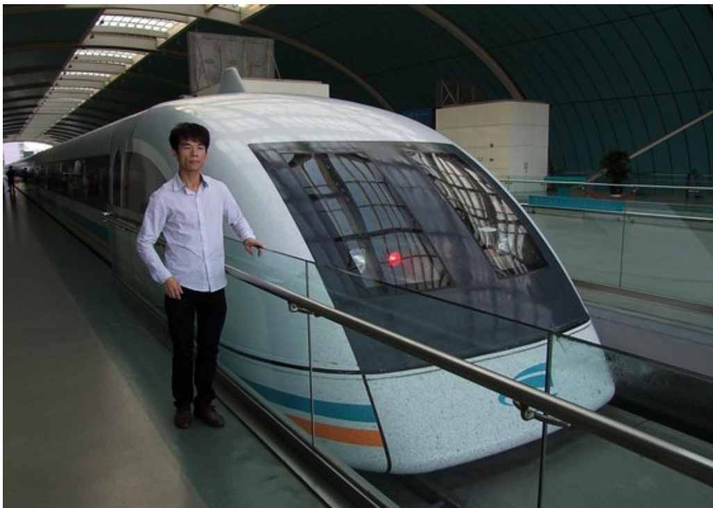
Obr.26 Čínský Transrapid využívající EDS [34]
