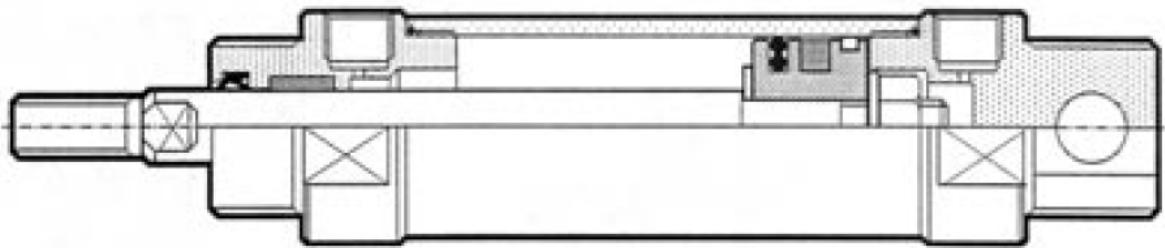
Obr. 7 Dvojčinný pneumatický válec
