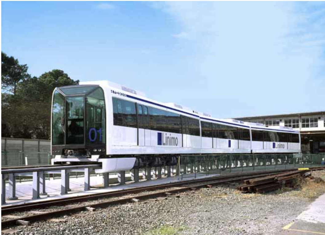
Obr. 23 Magneticky levitovaný vlak HSST – Linimo [24]
