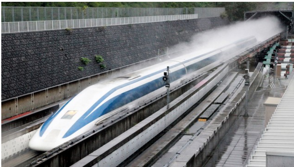
Obr. 24 Magneticky levitovaný vlak JR – MAGLEV[24]
