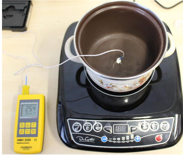
Obr. 3.9 Fotografie měření teploty v závislosti na čase
