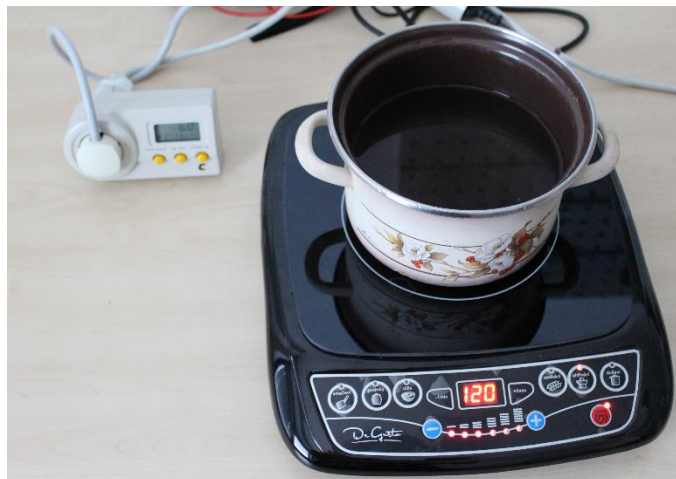
Obr. 3.7 Fotografie měření proudu pomocí power monitoru
