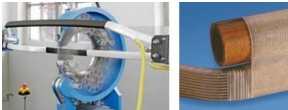
Obr. 1.1 a) Kontinuální navíjení páskou, b) diskontinuální navíjení fólií, převzato [9]
