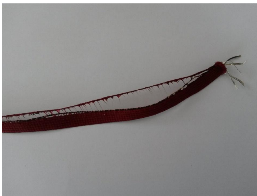
Obrázek 7- Vodivý tkaloun, vodič po průchodu vysokého elektrického proudu
