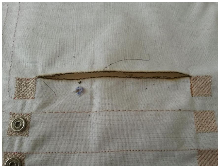
Obrázek 15 - přetavení látky vlivem proudové zátěže
