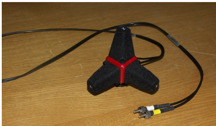
Obr. 15: Sonda elektrického pole HI-6005
