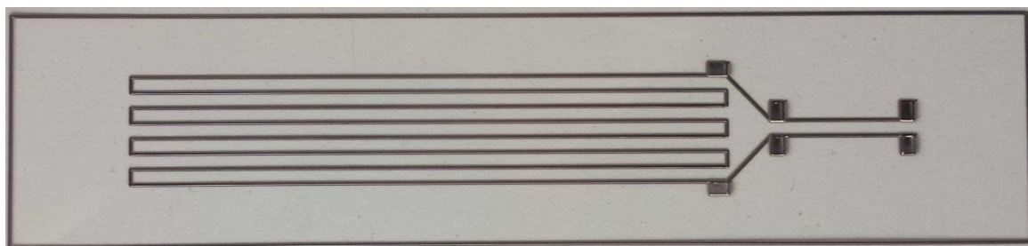
Obr. 34 Vzorek připravený AJP metodou ve čtyřech vrstvách.
