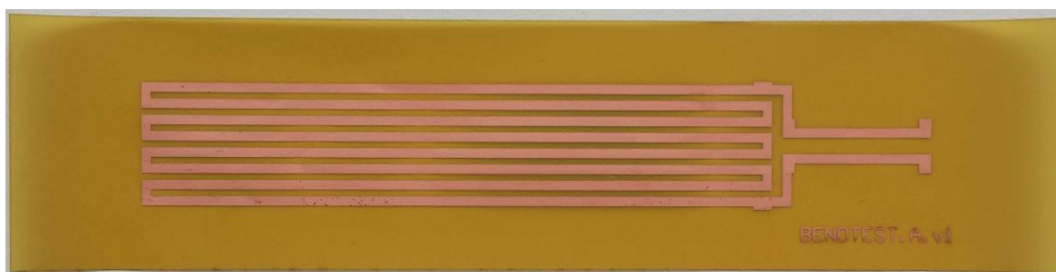
Obr. 36 Vzorek na kaptonové fólii.
