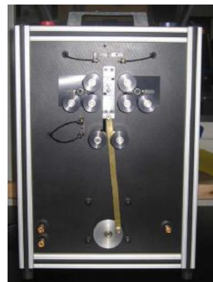
Obr. 14 Fotografie zařízení pro ohýbání pomocí vychylování trnů [49].
