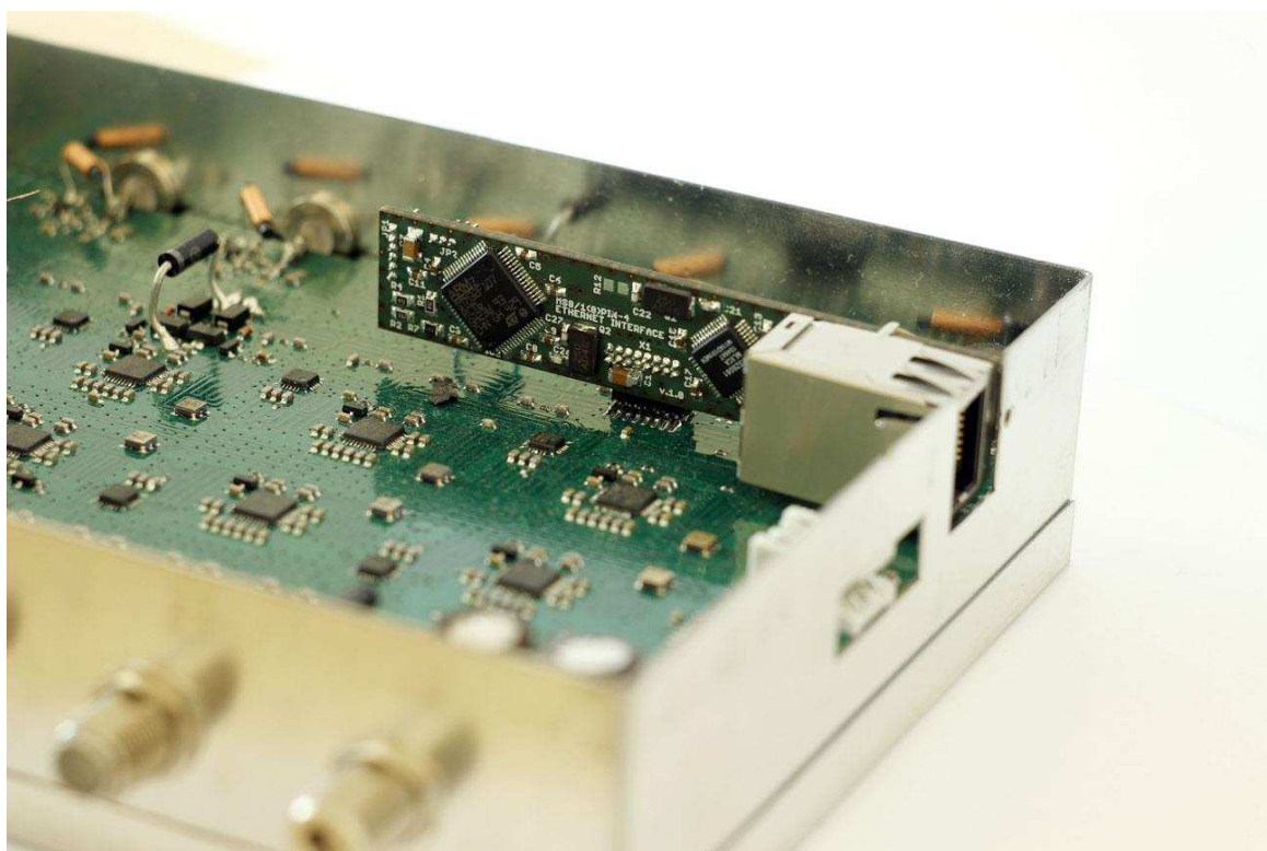
Obr. C.5: Fotografie realizovaného zařízení nainstalovaného v multipřepínači.
