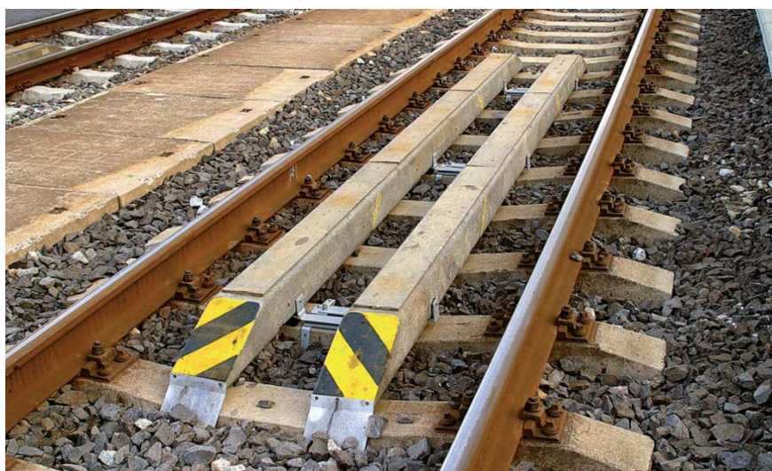
Obrázek 37 – Umístění magnetických informačních bodů MIB [44]
