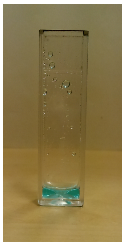
(a) Ukázka nesmáčivosti stěn a nerovného dna kyvety
