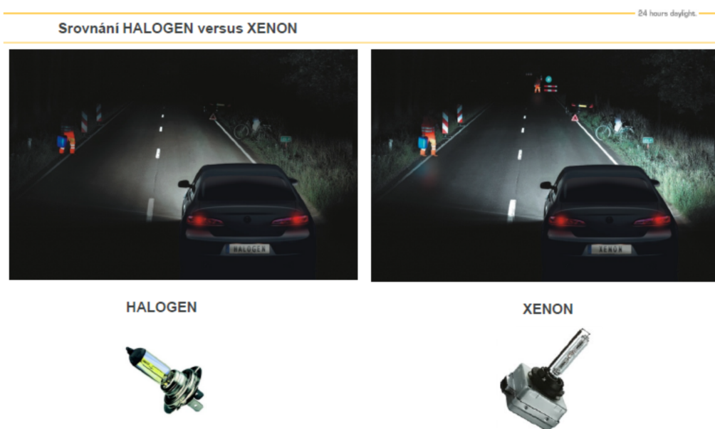
Obr. 2.3: Srovnání viditelnosti na vozovce s použitím halogenových žárovek vs. xenonových výbojek [1]
