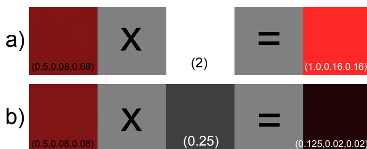
Obr. 4.15: Princip barevného operátoru násobení vektoru skalárem [Převzato z [30]]
