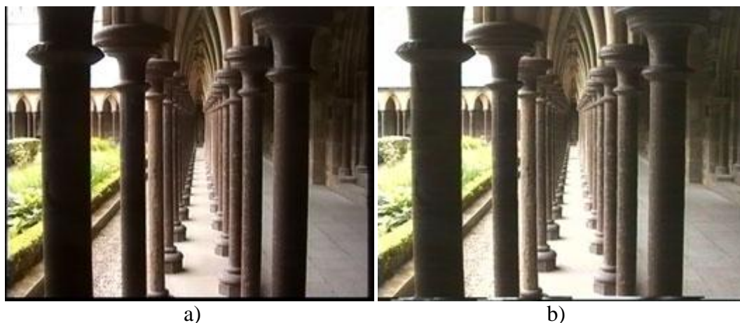
Obr. 2.3 Porovnání obrazu s použitím korektoru časové základny (a) a bez použití korektoru (b) [41]
