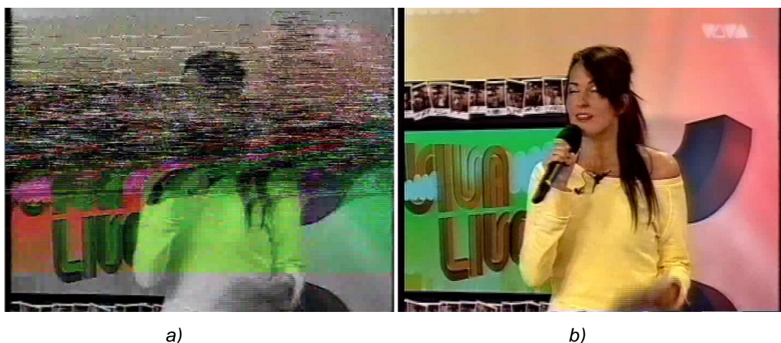
Obr. 5.1 Oprava výpadků obrazu. Původní video bez TBC a) a video s TBC b)
