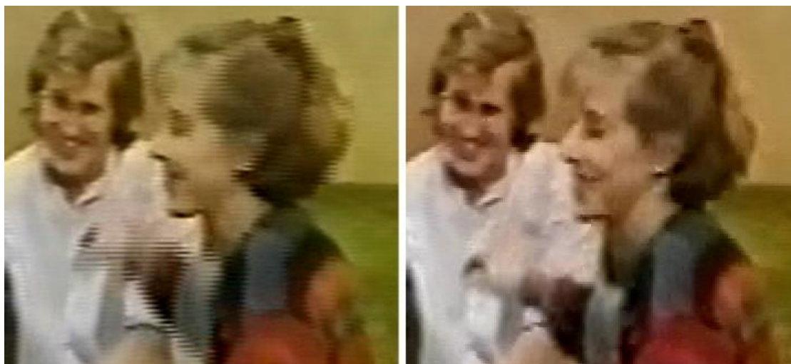
Obr. 5.14 Odstranění prokládání. Původní video a) a opravené video b)
