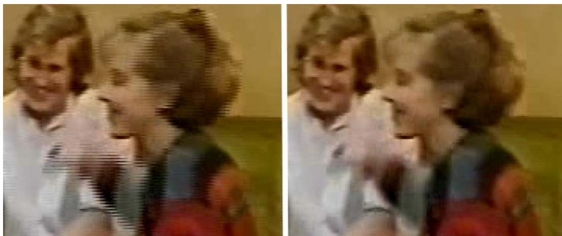
Obr. 5.4 Odstranění prokládání. Původní video a) a opravené video b)
