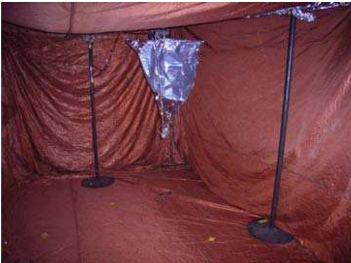
Obr. D2 Transportní intrinzická odrazová měřicí komora – pohled z vnitřního prostoru, převzato z [2].
