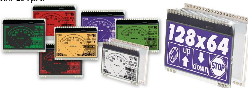
Obr.16: displej DOGM128-6 a podsvícení EA LEDx46 [Převzato z https://octopart.com/ea+dogm128w-6-electronic+assembly-20084404 ]
