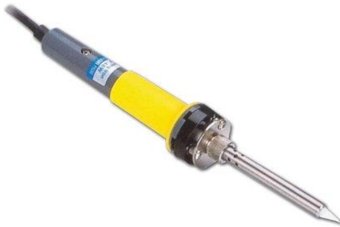
Obr.17: Použité pájecí pero, patřící ke stanici ZD-931
