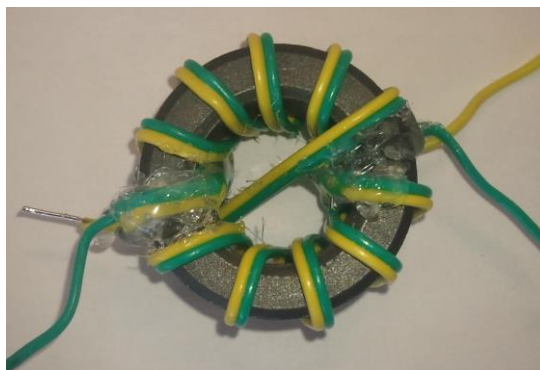
Obr. 4.11 Zhotovený Reiserťuv model Guanella balunu s přerušným vinutím
