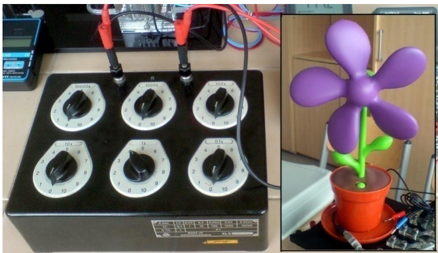
Obrázek 4.2: Použité zátěže - vlevo odporová dekáda, vpravo standardní zátěž
