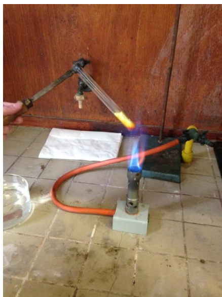
Obr. 10 Průběh změn barev síry při zahřívání
