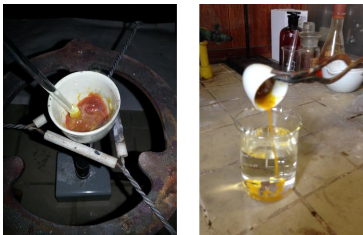
Obr. 12 Průběh přípravy jednoklonné síry
