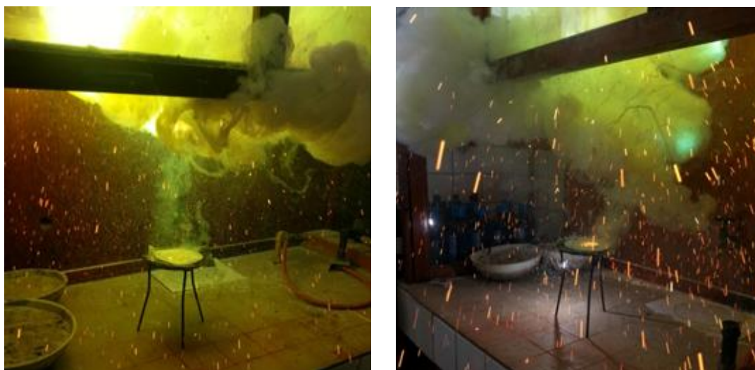
Obr. 27 Průběh reakce síry se zinkem po zapálení
