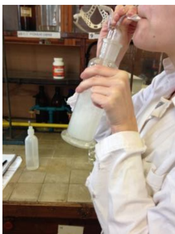
Obr. 25 - Vydechování oxidu uhličitého \text{CO}_2 do vápenné vody
