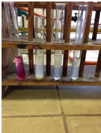
Obr. 18 - Důkaz zásadité reakce mýdla
