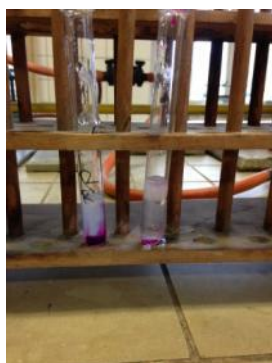
Obr. 12 - Reakce hořčíku a vápníku ve vodě
