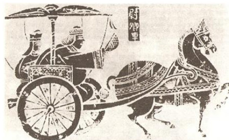
Obr. 105 - V Číně se prsní popruh používal téměř o 1000 let dříve než v Evropě
