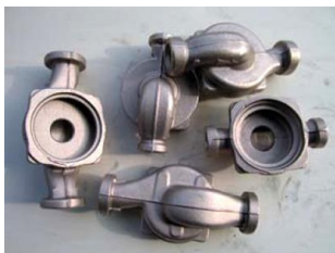
Obr. 25, 26 dělovina je vhodná pro výrobu přírub oběhového čerpadla i uměleckých výrobků.
