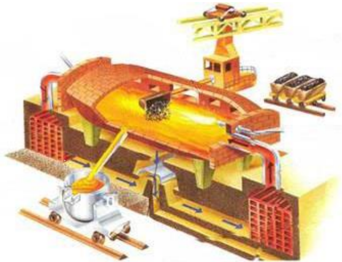
Obr. 58 Schéma zpracování surového železa v Siemens-Martinské peci
