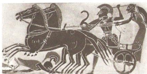
Obr. 107 – Asyrský vůz asi z roku 800 př. n. l. Postroj stlačoval koním průdušky.
