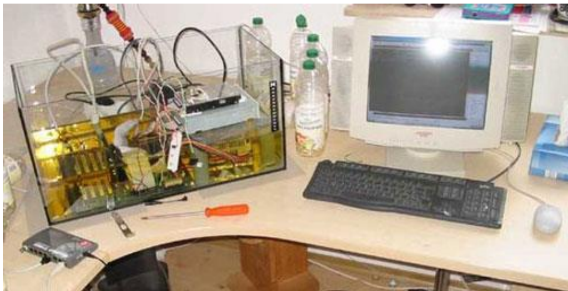
Obrázek 26: Počítač ponořený do akvária v rostliném oleji [27]
