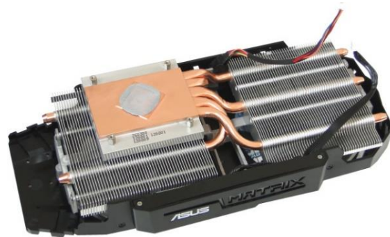
Obrázek 12: Chladič grafické karty s technologií heatpipe [18]
