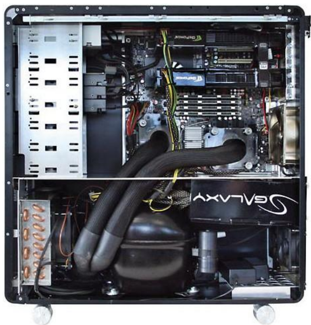
Obrázek 25: Kompresorové chlazení chipsetu a CPU [26]
