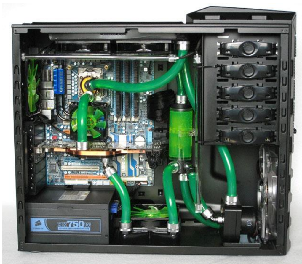
Doporučení montáže je začít od radiátoru do vrchní části skříně počítače, popřípadě mimo skřín. Dnes už je méně časté použití radiátoru mimo skřín, ovšem dnešní i sebelevnější počítačové skříně jsou vybaveny otvory pro hadice na vodní chlazení. Přes tyto otvory můžeme hadice vytáhnout ven a nemusíme mít strach, že by nastalo jejich zlomení, popřípadě proříznutí. Po umístění radiátoru je vhodné namontovat příslušné bloky na komponenty, které chceme chladit. Paměti, procesor, grafická karta popřípadě chipset.
