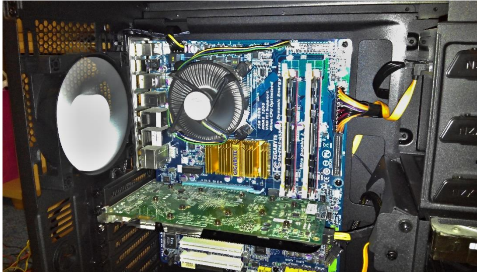
Obrázek 32: Testovaná sestava s box chladičem
