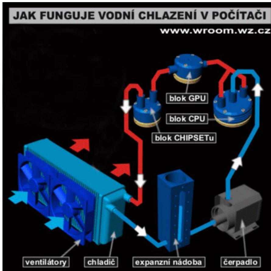
Obrázek 14: Princip vodního chlazení [20]
