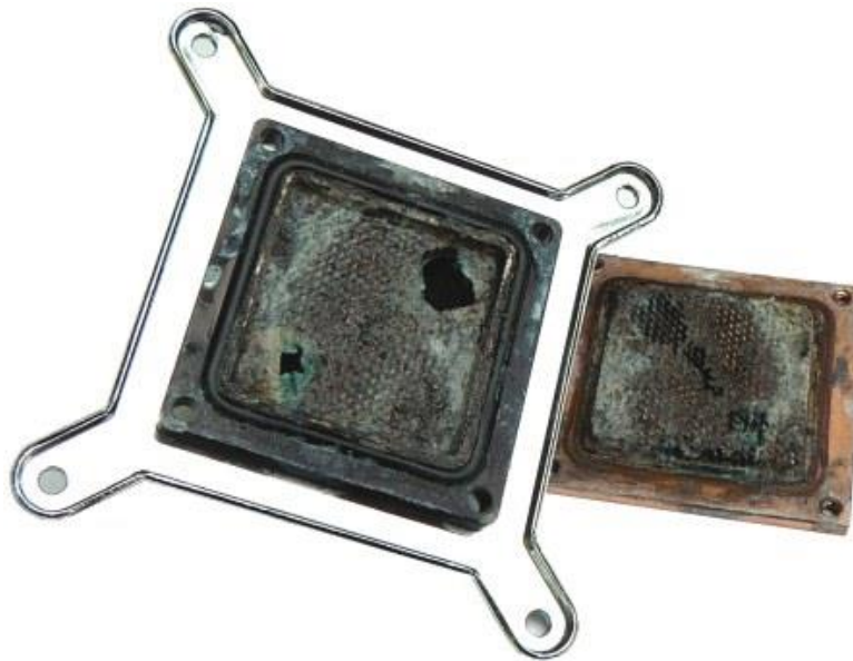
Obrázek 30: Galvanická koroze způsobená hliníkem ve vodním okruhu [31]
