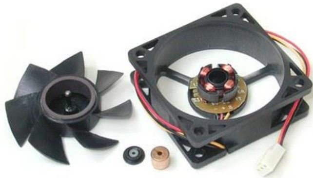
Obrázek 9: Ventilátor s kluzným ložiskem [15]
