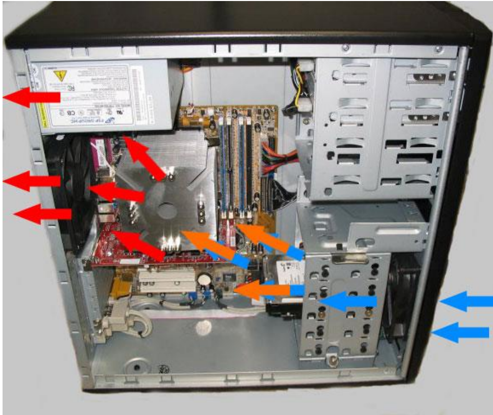
Obrázek 28: Ukázka správného proudění vzduchu v počítačové skříni [29]
