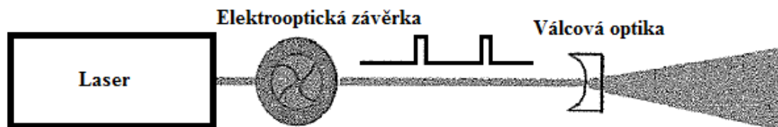
Obrázek 3 Přerušování laserového paprsku pomocí elektrooptické závěrky.
