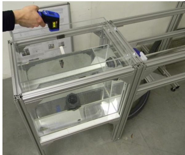
Obrázek 30 Měření teploty kapaliny pomocí infračerveného teploměru.
