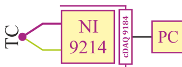
Obr. 8-4: Schéma měření teploty pomocí termočlánku
