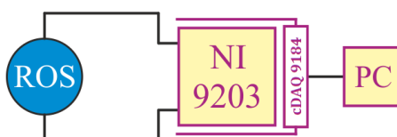
Obr. 8-8: Schéma měření relativního tlaku pomocí snímače Rosemount 2088
