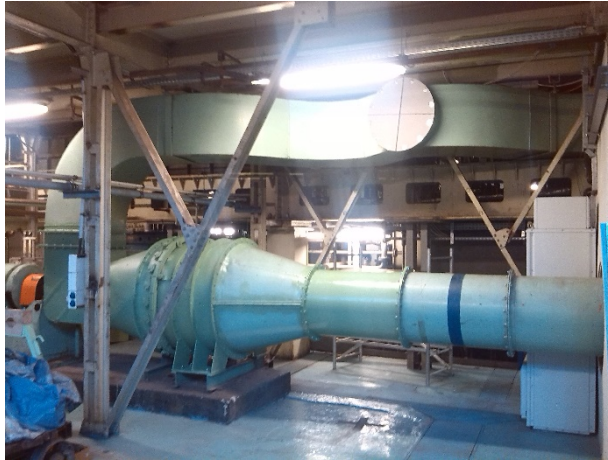
Obr. 2 Sání, pohon a ventilátor (po rekonstrukci 2014)
