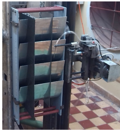
Obr. 34 Pohled na pětivotrovou sondu a traverzér
