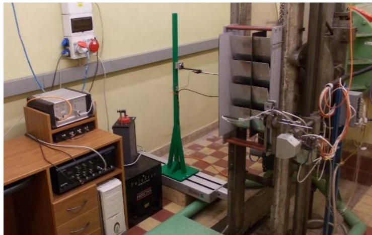
Obr. 14 Měřící aparatura CTA pro měření rychlostního profilu
