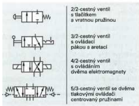
Obr. 2-12: Způsoby ovládání cestných ventilů [1]
