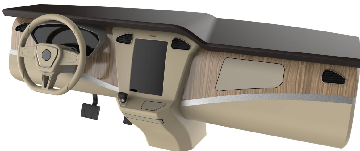
Palubní deska - varianta 2 – použití dřeva „ořech“ a tmavé horní desky - dekorace s lištami imitující kov
