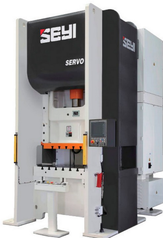
Obr 6 Klikový lis SEYI SD1 s přímým pohonem [9]
