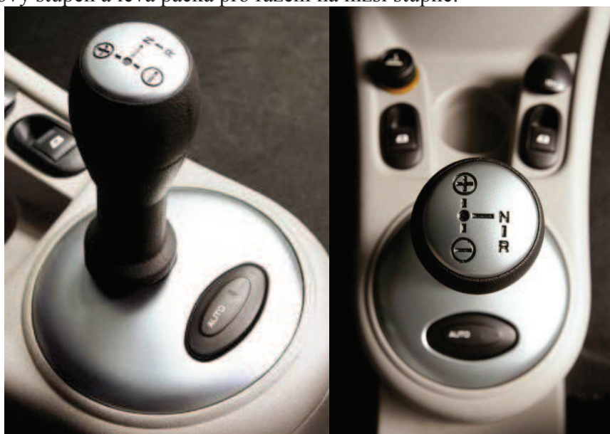
Obrázek 23 Páka voliče převodovky SensoDrive spolu s tlačítkem „AUTO“ pro zvolení plně automatického chodu [6]
