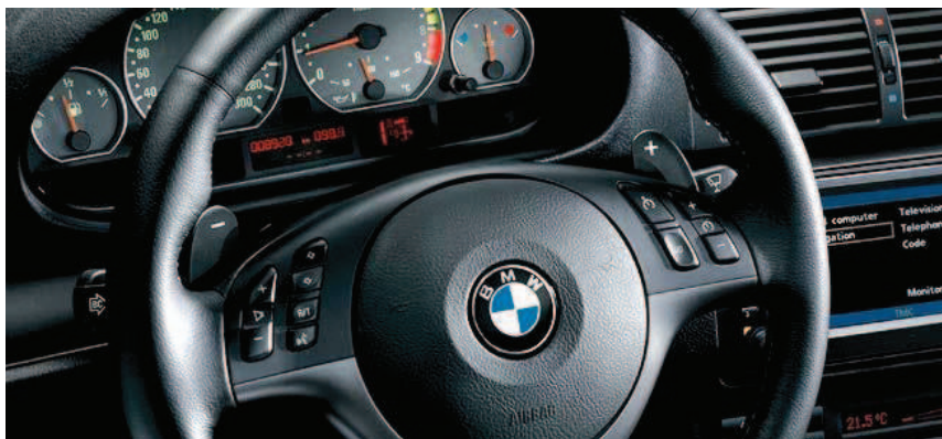
Obrázek 18 Ovládací páky převodovky SMG BMW M3 [3]
