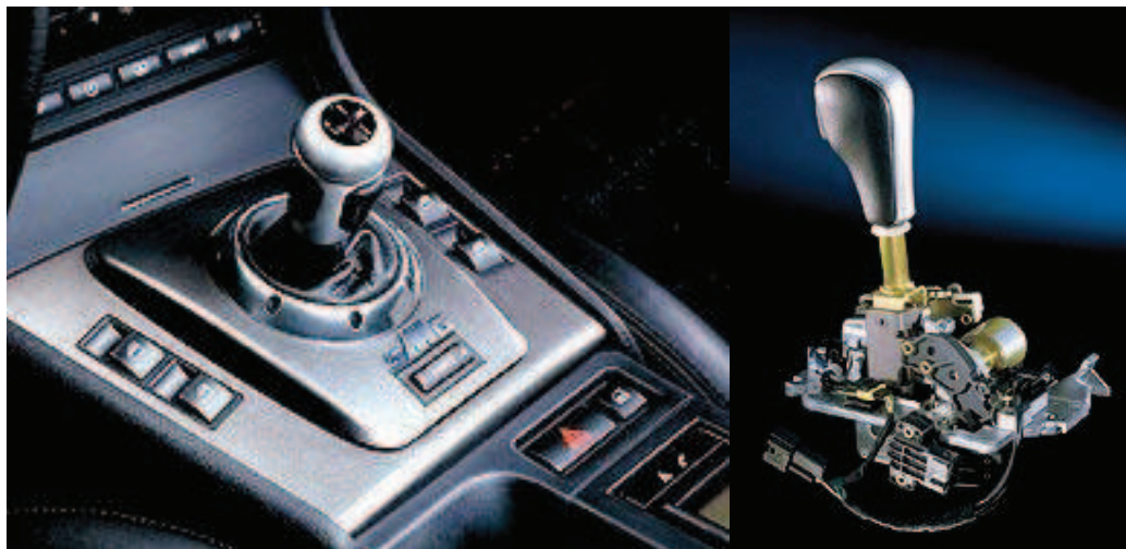
Obrázek 19 Řídicí páka převodovky SMG u modelu BMW M3 e46 (vlevo), řídicí mechanismus (vpravo) [25]
