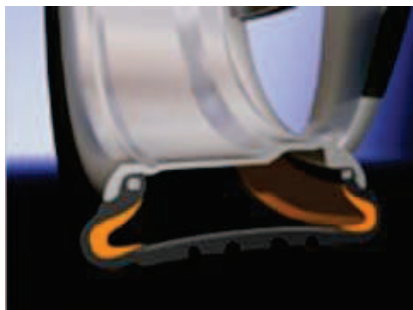
Obrázek 39 Runflat při ztrátě tlaku [27]
