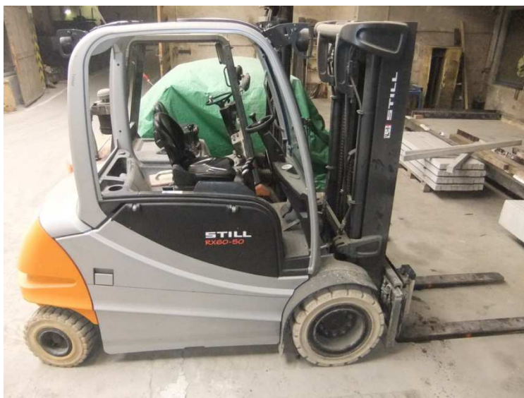
Obr. 18. Zdvihací mechanismus Triplex
