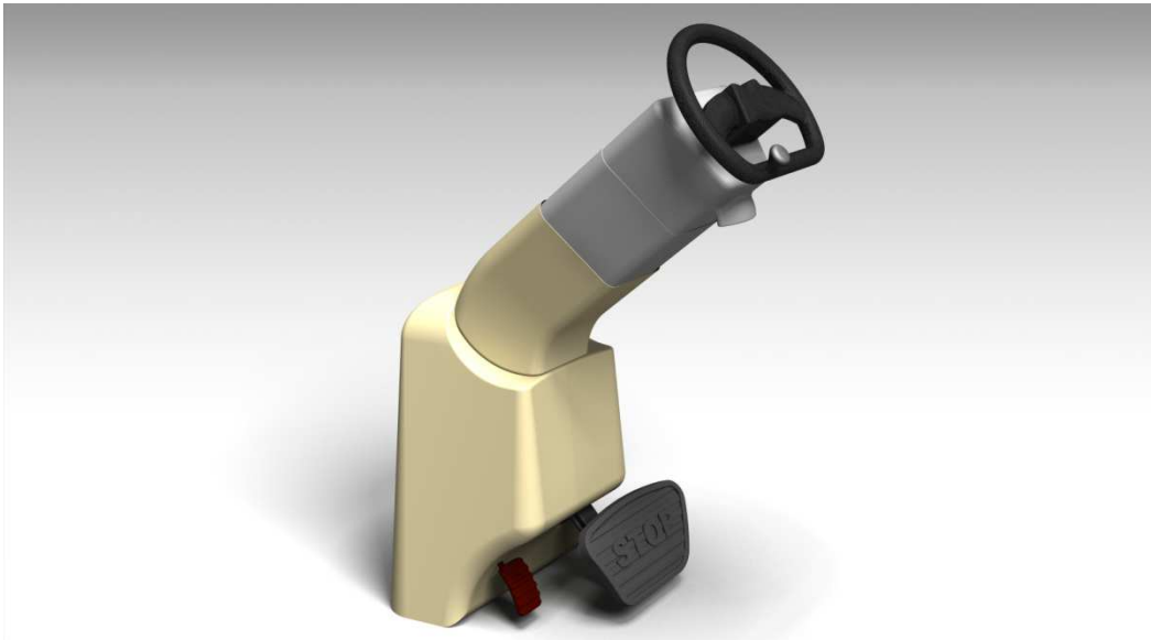
Obr. 41. Výškově nastavitelný sloupek s volantem, brzdový pedál a pedál odjištění volantu
