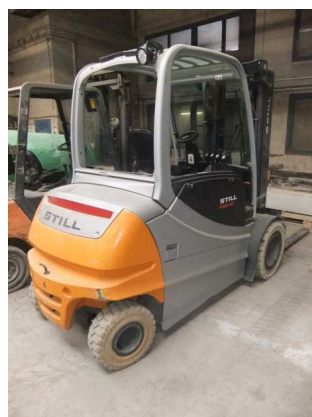
Obr. 20. Protizávaží vozíku Still RX 60 - 50
