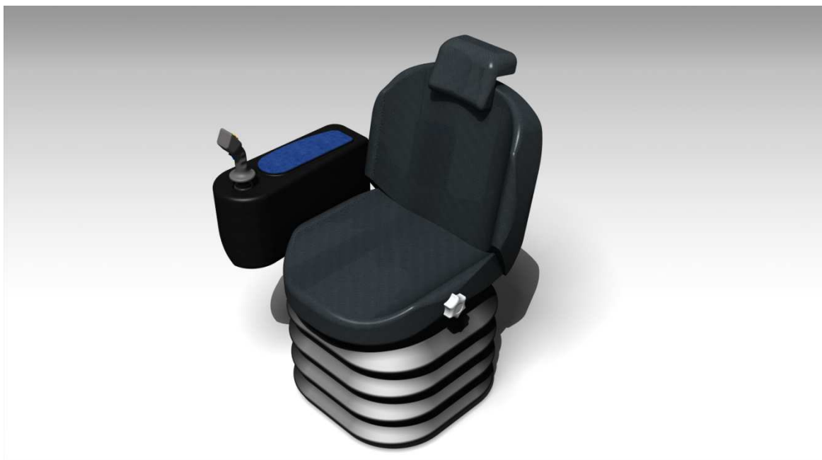
Obr. 34. Render sedadla s ovládacím joystickem
