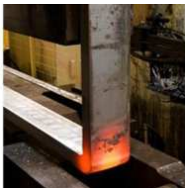
Obr. 19. Výroba vidlic vysokozdvížného vozíku [15]
