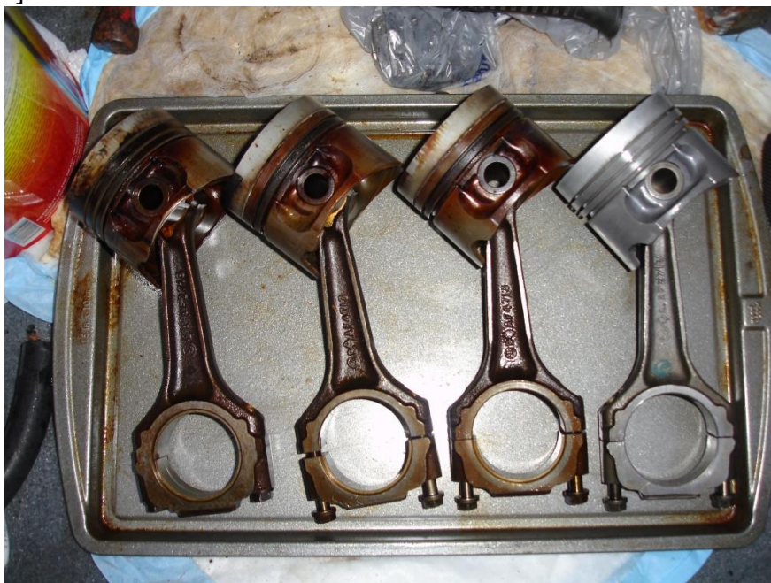
Obr. 21 Porovnání nového pístu s ojnicí a opotřebovaných pístů s ojnicemi se značnou korozi. [45]
