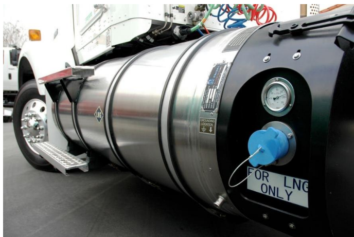
Obrázek 10: Pohled na konkrétní použití kriogenní nádrž LNG u nákladního automobilu [13]
