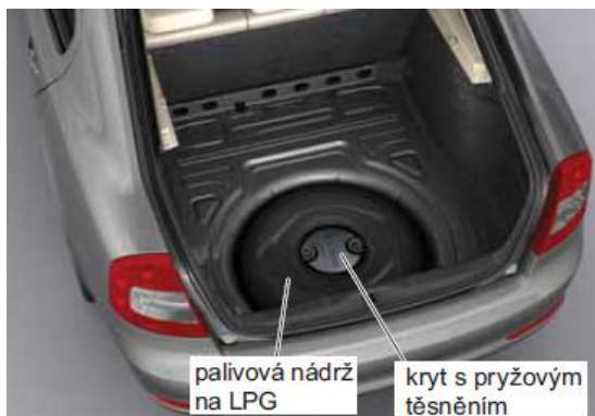
Obrázek 46: Umístění palivové nádrže LPG. [6]
