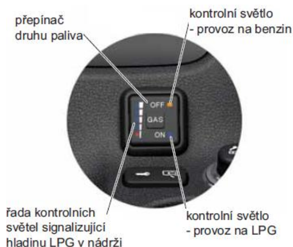
Obrázek 72: Ukazatel zásoby LPG – diody. [6]
