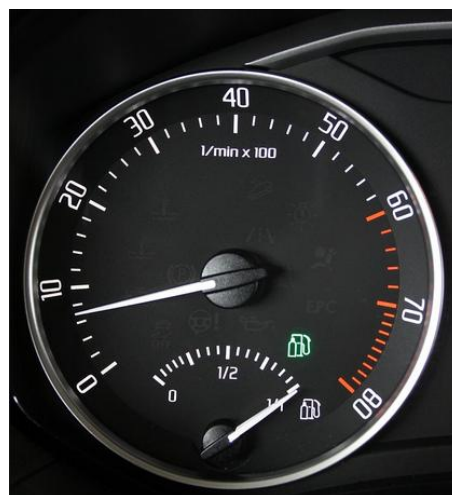
Obrázek 73: Ukazatel zásoby LPG – analogové řešení. [6]
