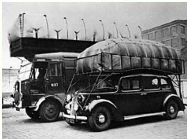
Obrázek 2: Plynové vaky připevněné ke střechám automobilů [10]
