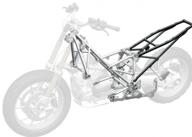
Obr. 5 – dvoudílný rám BMW R1200GS [2]
